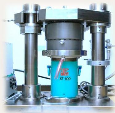
冷压作业提取椿油原油
